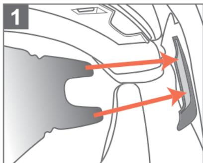
1. Führen Sie die Laschen an der Sonnenblende in Pfeilrichtung in den Mechanismus ein, bis das innere Visier sich nicht mehr weiterschieben lässt. Wiederholen Sie den Vorgang auf der anderen Seite und prüfen Sie die Position.
