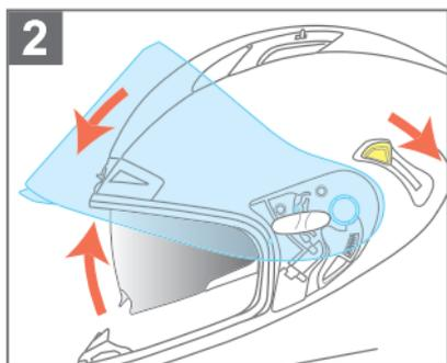
2. Schieben Sie den Sonnenblendenschalter, um die Innenblende wieder in die Schale einzufahren, und kontrollieren Sie auf Leichtgängigkeit.
