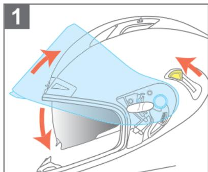
1. Drehen Sie das Visier auf seine vollständig offene Position. Klappen Sie mit dem Sonnenblendenschalter seitlich am Helm die innere Sonnenblende herunter.
