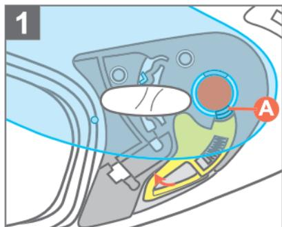
1. Führen Sie das Visier in seine geöffnete Position über die runde Öffnung auf beiden Seiten. Achten Sie dabei darauf, dass die Lasche (A) am Hebel zur Visierentsperrung ausgerichtet ist.
