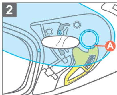
2. Ziehen Sie den Hebel zur Visierentsperrung, und drücken Sie gleichzeitig das Visier fest in seine Position.
