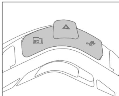
Der Forcite-Helm und die Steuerung verfügen über je eine Zugangsabdeckung aus Gummi, die über die Ladeanschlüsse und den SD-Kartensteckplatz passt.
