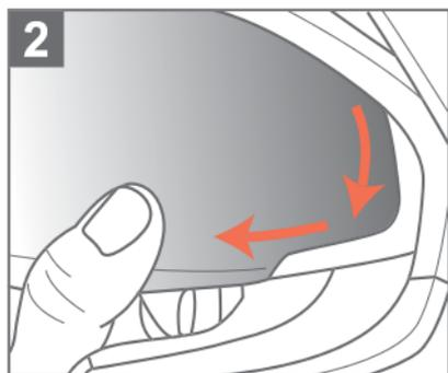
2. Drehen Sie das innere Visier so lange nach unten, bis Sie einen kleinen Spalt sehen. Ziehen Sie dann kräftig nach außen, um die Sonnenblende vom Mechanismus zu lösen.
