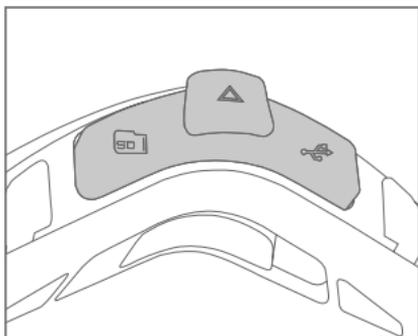
Il casco e il controller Forcite sono dotati di una copertura in gomma che copre le porte di ricarica e lo slot per la scheda SD.
