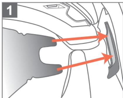
1. Inserire le linguette del parasole nel meccanismo in direzione della freccia fino all'arresto della visiera interna. Ripetere l'operazione sull'altro lato e verificarne la posizione.
